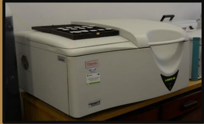
fluorescencji rentgenowskiej (XRF) z użyciem spektrometru ARL Quant'X EDXRF (Thermo Scientific)
