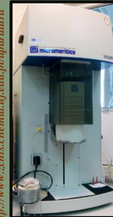
porozymetrii/BET opartej na sorpcji azotu w temperaturze -196\text{ }^{\circ}\text{C} , przy użyciu zestawu Micromeritics 3flex
