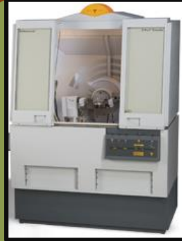
proszkowej dyfraktometrii rentgenowskiej (XRD) przy użyciu dyfraktometru XPert3 Powder wyposażonego w lampę rentgenowską CuK_{\alpha}
