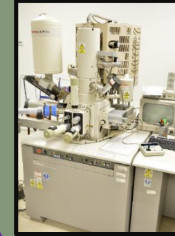
skaningowej mikroskopii elektronowej (SEM) z analizą EDS z użyciem mikroskopu Hitachi S-4700 Scanning Microscope .
