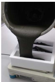
Rys. 1. Próbkę w czasie odlewania do formy. Fig. 1. Sample during casting
