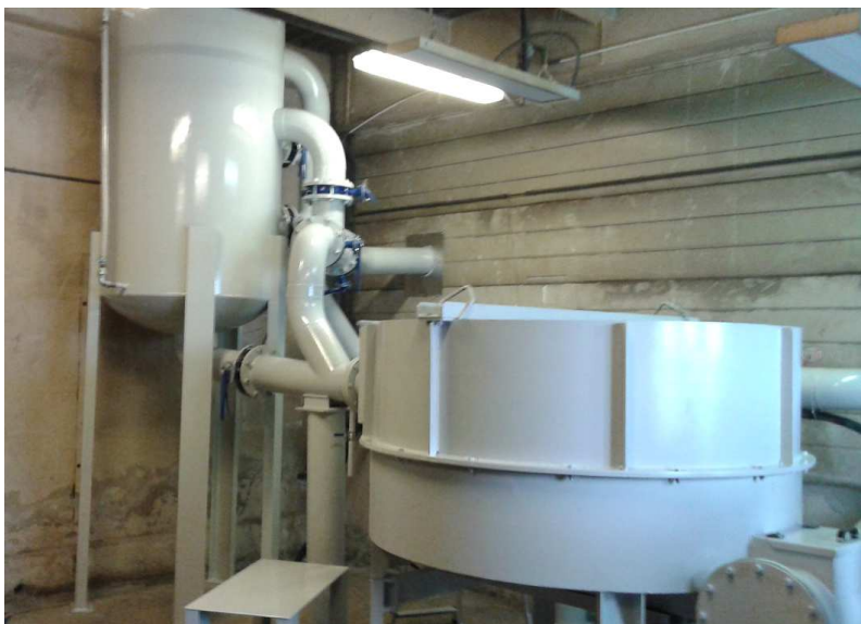
Rys. 4. Wygląd pilotowej instalacji OSO do klasyfikacji ziarnowej i odwodnienia zawiesziny wód odciekowych w Elektrowni Łaziska Tauron Wytwarzanie SA
